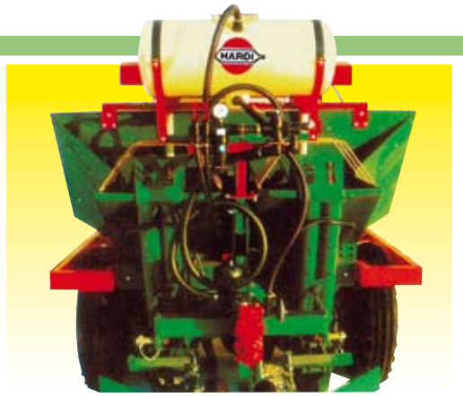
BD 100 I beholder og BK armatur monteret på kartoffellægger.
